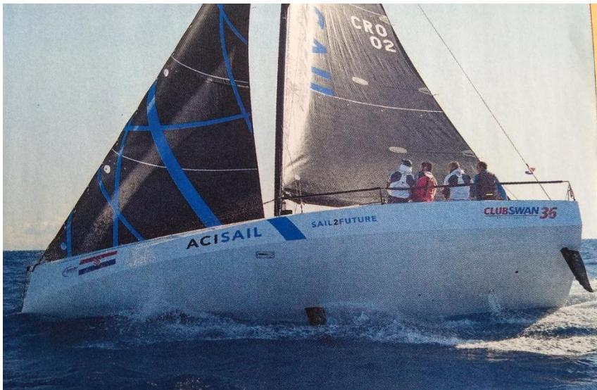
**Carène en coin.** La gîte du bateau permet d'apercevoir le haut du voile de quille (qui descend à 2,75 mètres !) et la taille plutôt réduite des safrans.
